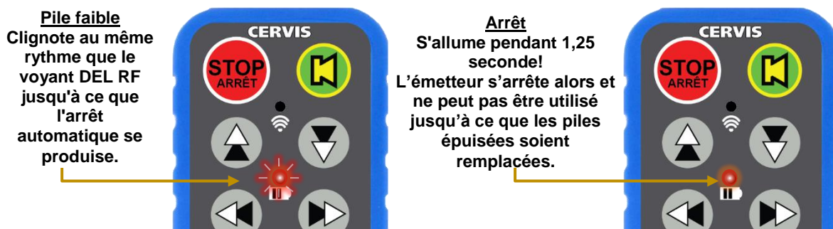
Figure 4. Avertissement de pile faible de la télécommande et arrêt du HH2S-9XW08
